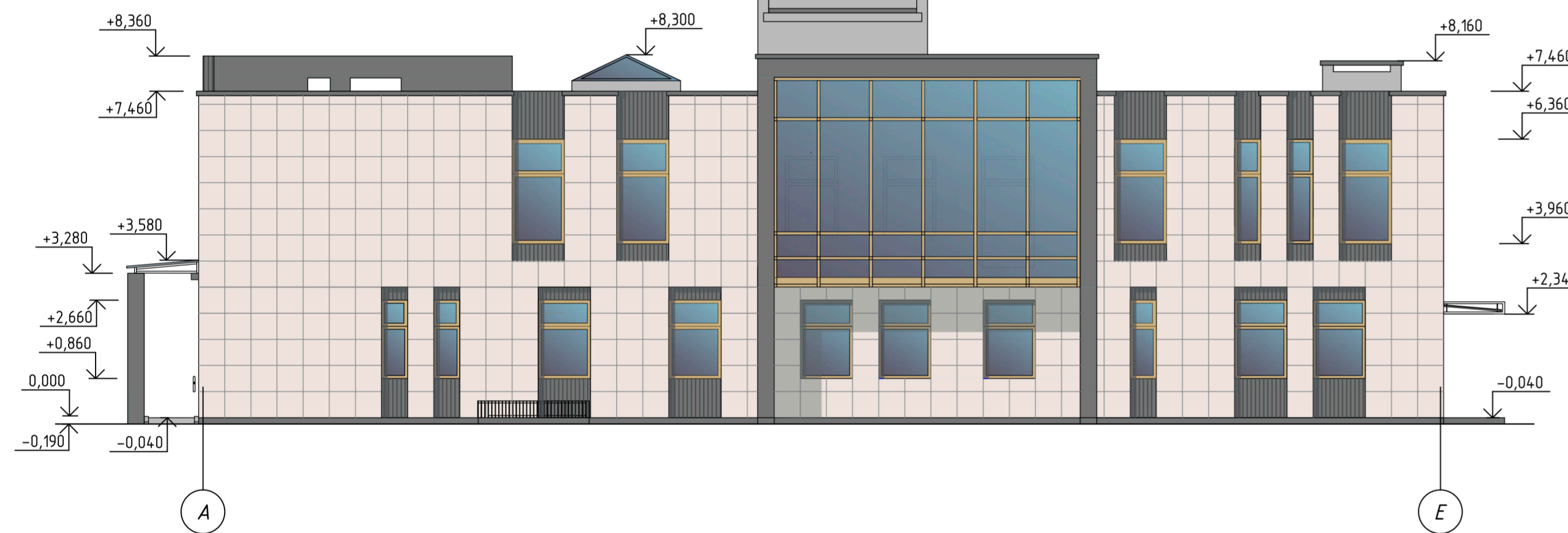
Фасад в осях А-Е М 1:100
